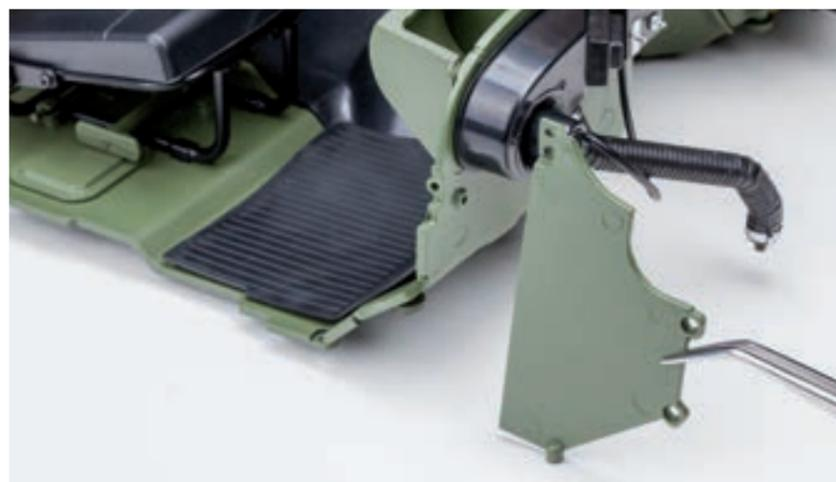
**Шаг 12.** Установите панель салона в ногах пассажира. Для этого закрепите панель двумя винтами 1,7×4 (EM) на вертикальной части перегородки моторного отсека и одним винтом 1,7×4 (CM) с нижней стороны пола салона.
