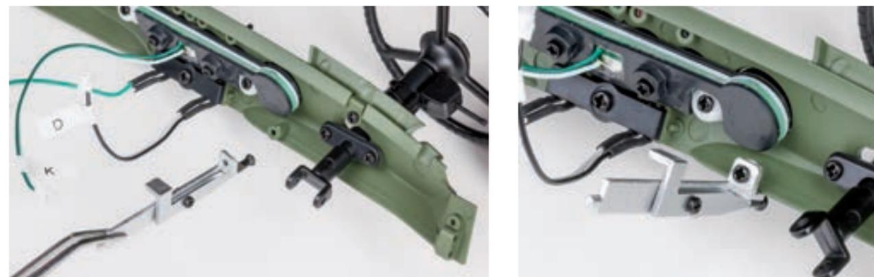
**Шаг 2.** Установите собранную рукоятку люка с внутренней стороны в левой части панели приборов. Совместите крепежную проушину кронштейна рукоятки с ответным отверстием панели приборов и закрепите детали винтом 1,7×4 (АР).
