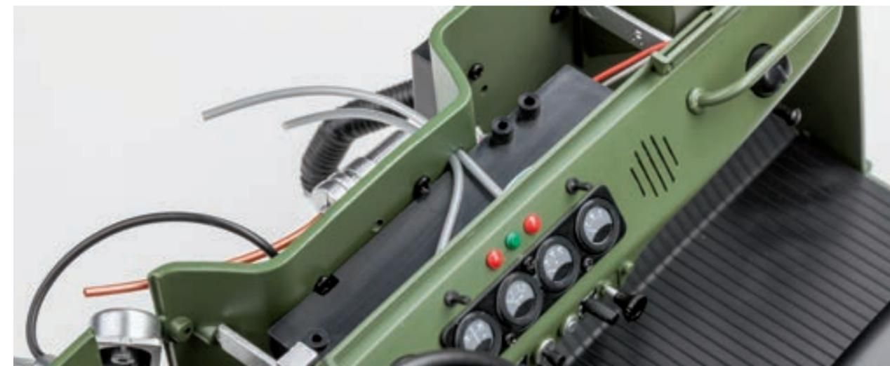
**Шаг 14.** Вставьте свободные концы тросов управления заслонками карбюратора в овальное отверстие на перегородке моторного отсека, расположенное над корпусом отопителя.
