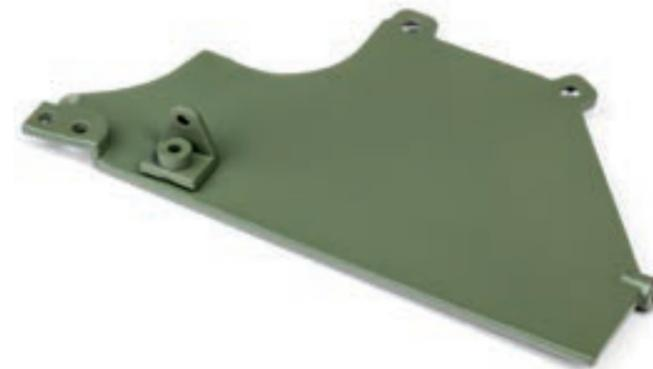
**Шаг 7.** При помощи винта 1,7×4 (DP) закрепите кронштейн ручки привода жалюзи на левой панели салона в ногах водителя.
