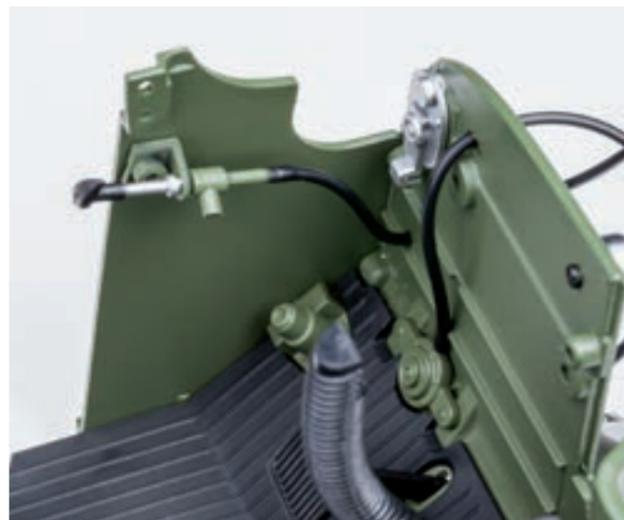
**Шаг 11.** Протяните свободный конец троса привода жалюзи радиатора в отверстие перегородки моторного отсека, расположенное ниже корпуса выключателя аккумулятора.
