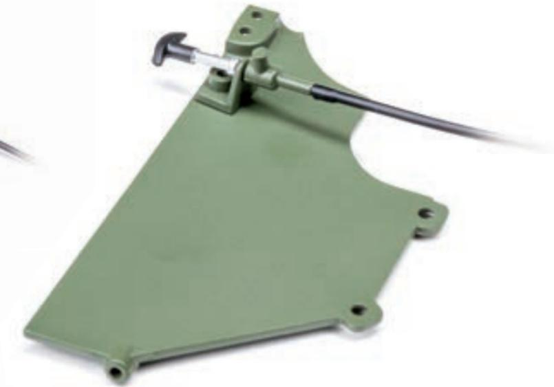
**Шаг 9.** Установите ручку привода жалюзи радиатора в отверстие кронштейна на панели салона. С обратной стороны кронштейна закрепите на центральном штыре ручки основание с закрепленным тросом привода жалюзи радиатора. Плотнo прижмите детали друг к другу.
