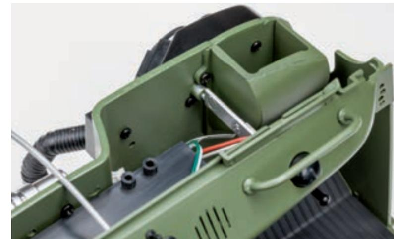
**Шаг 13.** Разместите собранную ранее панель приборов в верхней части перегородки моторного отсека. Совместите крепежные штыри кронштейнов рукоятки люка и ручки управления крышкой воздуховода с ответными отверстиями на перегородке моторного отсека. Закрепите панель приборов при помощи четырех винтов 1,7×4 (AP) на левой и правой панелях салона.
